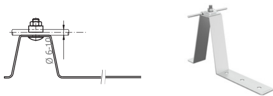
Держатель проводника на кровле
